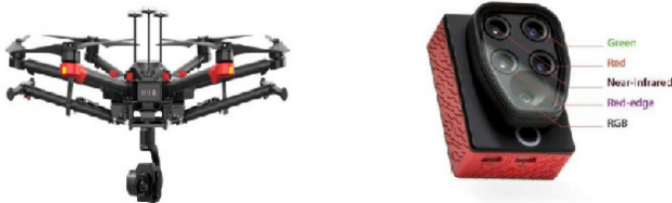
شکل ۱. تجهیزات پایش سرمازدگی (سمت راست: دوربین چندطیفی، سمت چپ: پهپاد)
