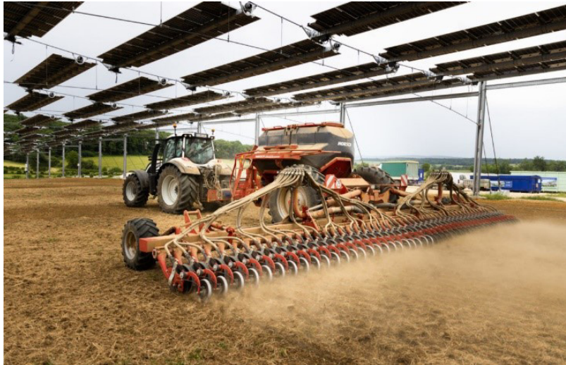
تصویر ۴. تسهیل حرکت ماشین‌های کشاورزی با کاهش سطح صفحه‌های خورشیدی
