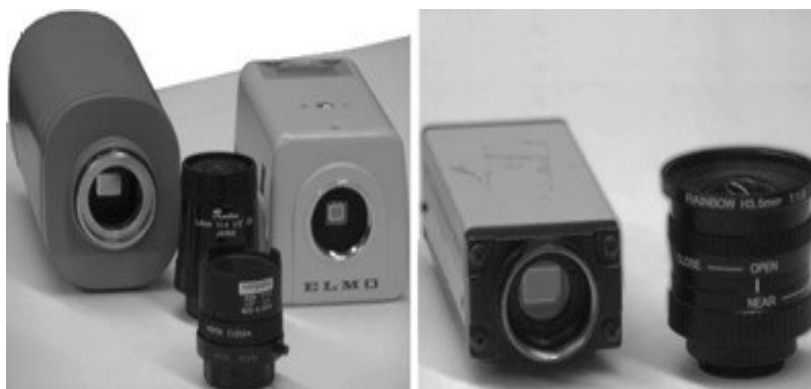
شکل ۴. دوربین‌های تک‌چشمی برای ادراک بصری در وسایل نقلیه هوشمند
