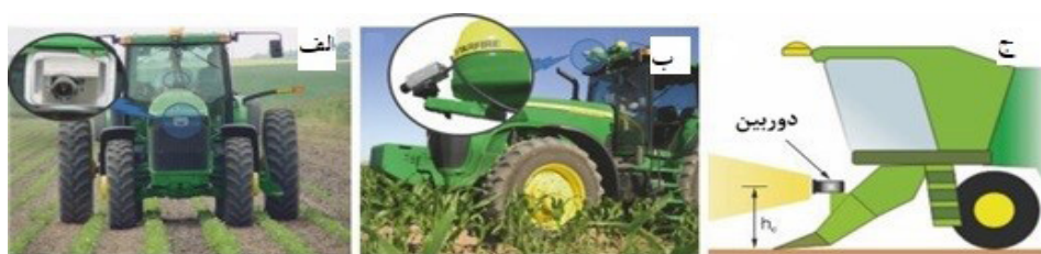
شکل ۵. موقعیت‌های دوربین: (الف) جلوی دماغه تراکتور؛ (ب) بر روی اتاقک تراکتور؛ (ج) در جلوی دروگر
